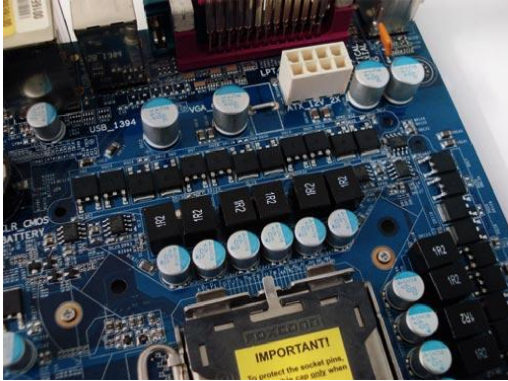
مادربردی همراه با خنک کننده Passive بر روی ترانزیستورهای مدار تنظیم کننده ولتاژ ( شکل ۲ )
